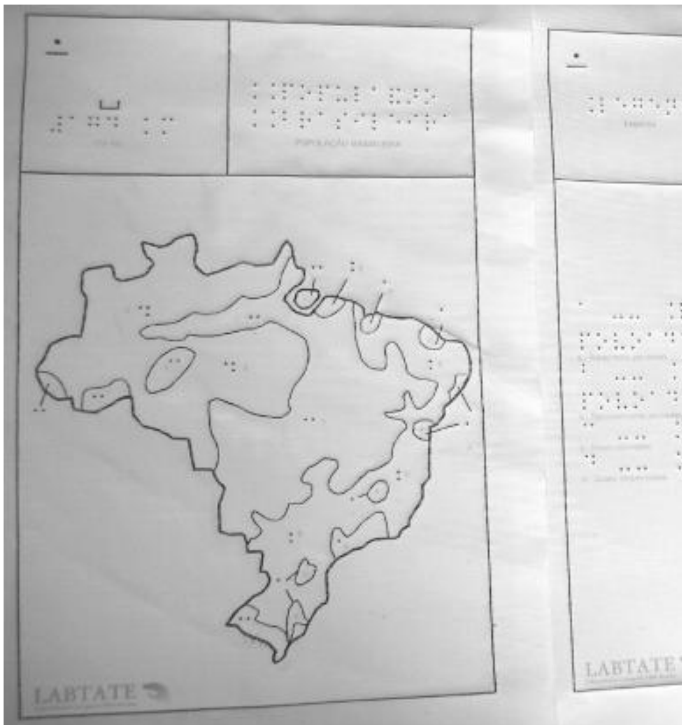
Figura 4 – Exemplo de mapa produzido em papel microcapsulado e mapa para o atlas geográfico tátil
