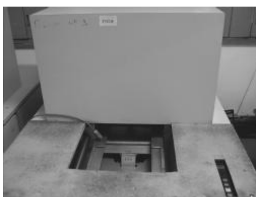
Máquina de estereotipia braille PED-30
