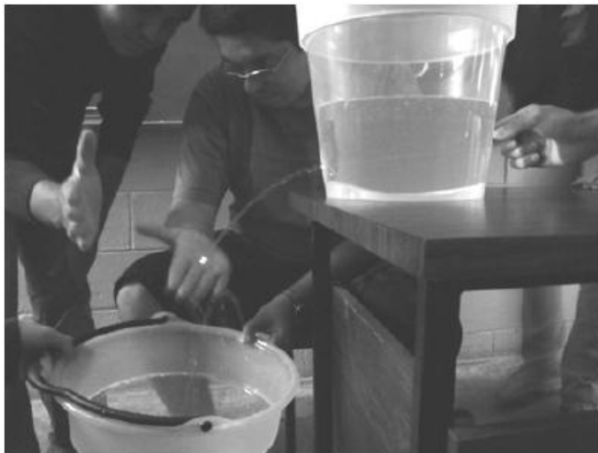
Foto 1. Foto do balde com água escorrendo e do laser acompanhando o jato.
