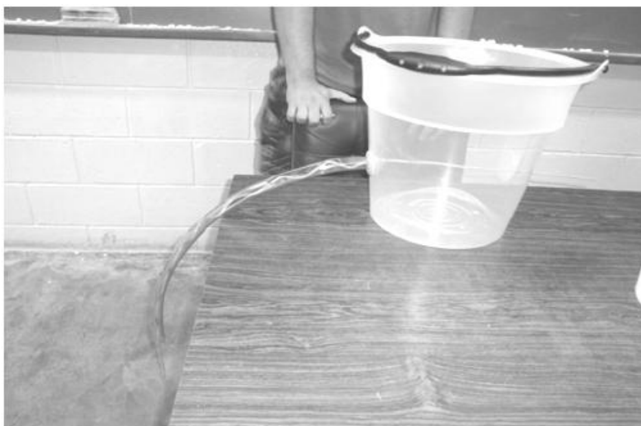
Foto 3. Princípio de funcionamento da fibra óptica. Representação do laser acompanhando o fluxo de água proveniente do balde.
