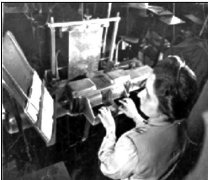
Figura 3: Regina Pirajá em máquina para criação de matriz em alumínio com estanho para transcrição braille na Fundação Dorina, em 1946. Na ocasião, a produção das chapas de metal seguia procedimento manual.
